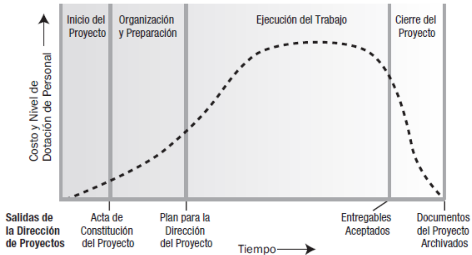
Figura 2. Niveles típicos de costo y dotación de personal en el ciclo de vida del proyecto.
