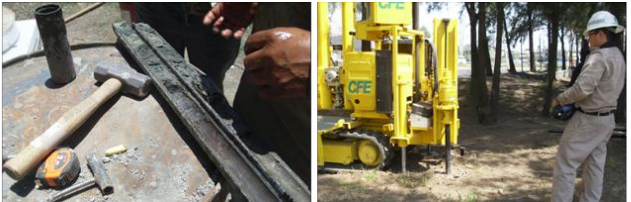
Figura 21. Sondeos Mixtos, recuperación de muestras de suelo
