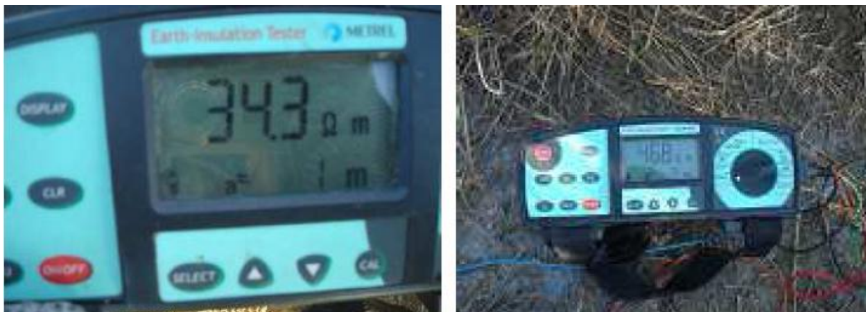
Figura 16. Medición de la resistividad del terreno
