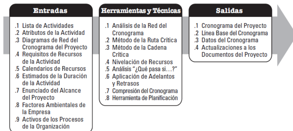
Figura N° 10. Diagrama de los requerimientos y productos esperados de la Gestión del Tiempo
